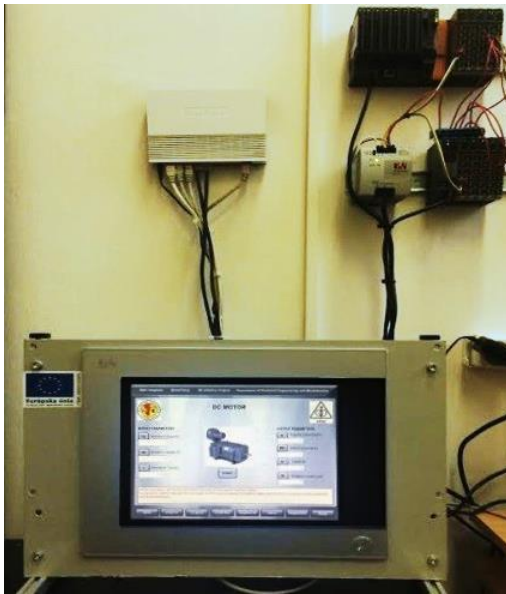
Pracovisko HIL simulácie (Hardware-In-Loop) pre verifikáciu metód riadenia pohonárskych systémov
